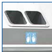
Hygieneschleuse, die sowohl bei Betreten als auch bei Verlassen der Betriebsräume zur Händedesinfektion und Sohlenreinigung /-desinfektion oder zur Stiefelschaftreinigung genutzt wird.
